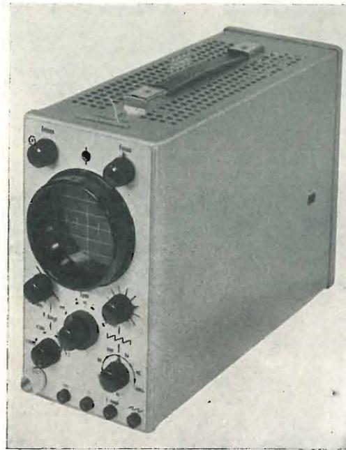
L'OSCILLARZET è l'apparecchio idoneo per il servizio di officina e per il servizio Clienti. Esso contiene un tubo a raggi catodici a traccia assai fine con uno schermo piano del diametro di 70 mm. L'amplificatore delle Y ha un campo di frequenza da 3 Hz a 4 MHz. Commutando su una banda di frequenza più ristretta (da 3 Hz a 400 kHz) si può ottenere una sensibilità decupla. La massima sensibilità è di 1800 mm/V<sub>pp</sub> (V<sub>pp</sub> = volt da picco a picco).
